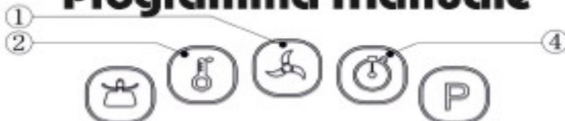
Per avviare la macchina impostare Velocità(1) e Temperatura(2). Dovresti sapere che non sei obbligato a usare tutte le impostazioni: Il Tempo non è obbligatorio: se lo si programma, l'unità eseguirà il conto alla rovescia e si fermerà una volta trascorso il tempo. Se non lo programmate, il dispositivo indicherà il tempo trascorso dall'inizio del programma e non si fermerà automaticamente (quindi, sarà necessario monitorare la lavorazione)
