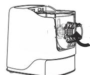
Inserire il dado [ghiera] (7) avvitandolo in senso orario. Verificando che sia completamente avvitato fino in fondo.
