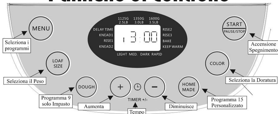
Collegando la spina alla presa di corrente (220/240V-50/60Hz), la macchina emetterà un 'bip' di controllo elettronico e il display mostrerà '3:00'. I due punti tra 3 e 00 non lampeggieranno. Sarà selezionato il programma num '1'. La freccina del peso punterà su '1350g' e la doratura su 'MEDIUM'. Queste sono SEMPRE le impostazioni PREDEFINITE quando la macchina viene collegata alla presa elettrica o riaccesa dopo l'utilizzo.
