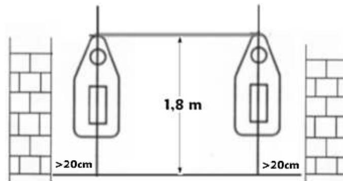
Fare 2 fori sul muro e tenere una distanza minima di 1,8m da terra. Il diametro del foro deve contenere tassello. Dopo aver infilato il tassello nel muro stringerlo al massimo. Assicurarsi che il gancio sia bel saldo e appendere la stufa nell'apposito foro.
